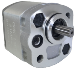
Bombas de Engranés KTI Serie PL Flecha Estriada 10 mm 11 Dientes Montaje 4PL 1.26 (2 Tornillos / Mamelón de 1.26")
