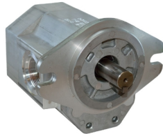
Bombas de Engranés Prince Serie SPD2 (Soporta configuración Tándem) Flecha Recta de 7/8" con Cuñero de 1/4" Montaje SAE B (2 Tornillos)
