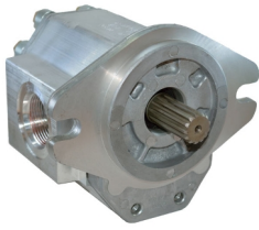
Bombas de Engranés Prince Serie SP25A Flecha Estriada de 7/8" 13 Dientes Montaje SAE B (2 Tornillos)
