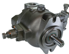
Bombas de Paletas Racine Serie PSV20 (Soporta configuración Tándem) Flecha Recta de 7/8" con Cuñero de 1/4" Montaje SAE B (2 Tornillos)
