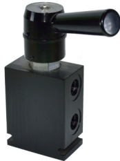
Válvulas Hidráulicas Direccionales Operadas Manualmente Hydraforce Serie MR10-47 4/3, Accionamiento Manual Regreso por Resorte o Enclavada por Trinquete Presión Máx. (PSI): 3500 Montaje en Línea
